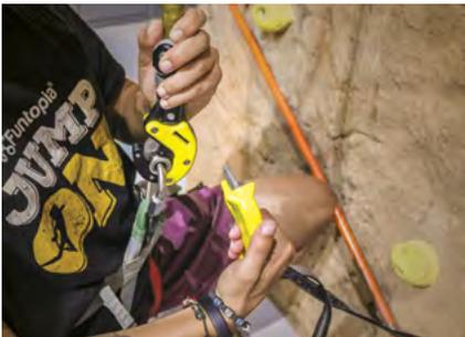
1 将自我确保装置键完全插入装置中。
