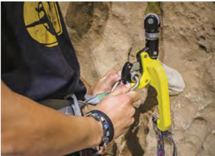
1 将吊带件插入自我确保装置中，直至其发出咔嚓声。
